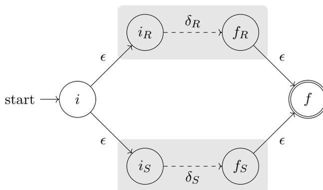
Esso comprende due “blocchi” che simulano il comportamento degli automi  $A_R$  e  $A_S$ , cioè all’interno dei quali la funzione di transizione  $\delta$  del nuovo automa segue i comportamenti di  $\delta_R$  e  $\delta_S$ , permettendo gli stessi percorsi di computazione. Si osserva però che, in questi blocchi, gli stati provenienti da  $A_R$  e  $A_S$  perdono i loro ruoli di stati iniziali e finali, che vengono invece assunti dai nuovi stati  $i$  e  $f$ .
