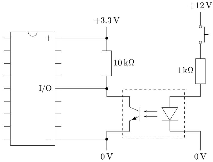
Così, quando il pulsante viene premuto, si accende il LED dell'optoisolatore, che fa accendere a sua volta il fototransistor, e questo porta vicino a 0 V la tensione alla porta di I/O. Quando invece il pulsante è aperto, il fototransistor non conduce corrente, dunque la porta di I/O rimane a 3.3 V (in questo esempio) grazie alla resistenza di pull-up.
