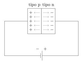
Se però la tensione applicata dalla batteria raggiunge un certo valore, chiamato tensione di rottura o di breakdown  $(V_{BR})$ , la corrente riesce ad attraversare la zona di svuotamento, e quindi a scorrere nel circuito (conduzione inversa), con anche il rischio di danneggiare (o bruciare completamente) il diodo.
