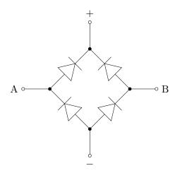
Quando una corrente alternata viene collegata ai terminali A e B, sui terminali + e - si ottiene una corrente continua (pulsante).
