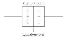
Il terminale collegato al semiconduttore di tipo p è detto **anodo** (A), mentre quello collegato al semiconduttore di tipo n è detto **catodo** (K).
