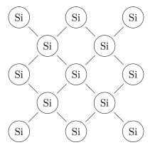
Non essendoci elettroni liberi di muoversi, a temperatura ambiente il silicio puro non conduce corrente (si comporta essenzialmente da isolante). È però possibile *drogare* il silicio, aggiungendo piccolissime quantità di altre sostanze i cui atomi hanno un numero diverso di elettroni.
