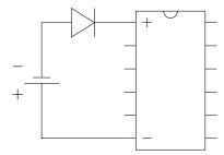
Quando poi la batteria viene ricollegata nel verso corretto, il diodo va in polarizzazione diretta, lasciando scorrere la corrente che alimenta il microcontrollore:
