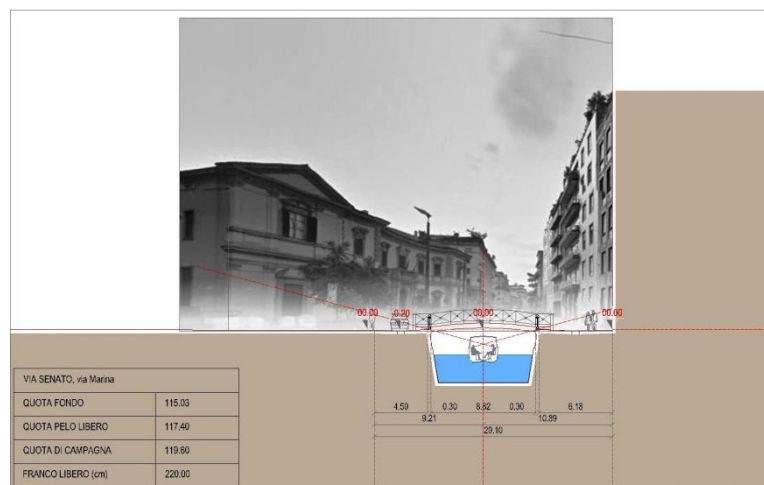
FIG. 3.2.3.2.11 Studio di fattibilità. Sezione del Naviglio in via Senato, all’incrocio con via Marina.
